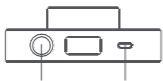
hlavné tlačidlo Napájací port Pre zapnutie stlačte hlavné tlačidlo, pre vypnutie podržte hlavné tlačidlo po dobu 3 sekúnd.
